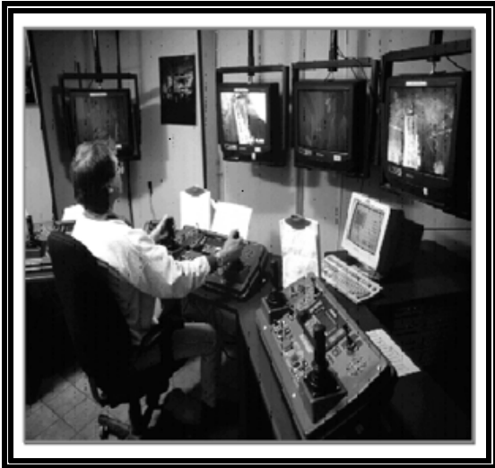
Salle de commande de l'équipement d'exploitation minière à distance (Photo fournie gracieusement par INCO - Programme d'automatisation des mines)
