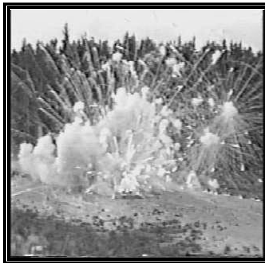
Effets d'une explosion expérimentale sur une pile de pièces pyrotechniques.
