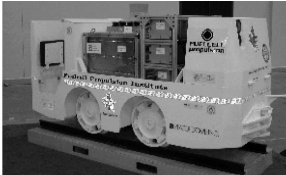
Une locomotive construite au Canada – le premier véhicule industriel du monde alimenté à l'hydrogène.
