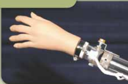
Un projet de Fonds pour possibilités nouvelles, dirigée par Professeurs Hani Naguib et Amor Jnifene de l'Université d'Ottawa, élaborent et construisent un mécanisme robotique d'accès linéaire (robotique à muscles artificiels) composé de matériaux « intelligent ».
