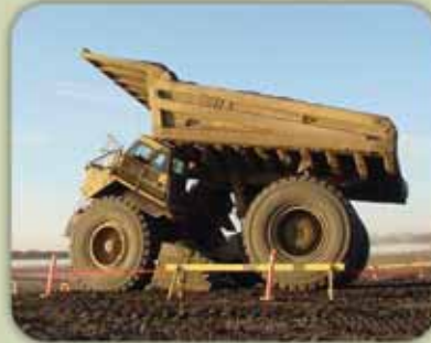
Le projet de Viseur de fissure surveille la croissance de fissures de fatigue dans le châssis des camions-bennes utilisés dans les sables bitumineux de l'Alberta.
