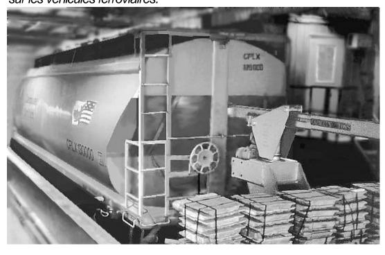
Cadre de serrage et de tension pour véhicule ferroviaire: essais en vraie grandeur des wagons de chemin de fer, à des forces de compression pouvant aller jusqu'à 1 million de livres.
