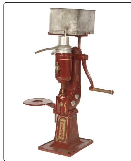
Après chaque usage, il fallait laver la cuve, les conduits et les lames de l'écrémeuse à l'eau chaude afin d'éliminer toute trace de lait rance qui aurait pu contaminer la prochaine production (D2780 3012C).
