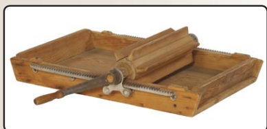
Avec ce modèle Philadelphia de la compagnie De Laval, la motte de beurre est malaxée par le mouvement de va-et-vient du rouleau. Cette entreprise offrait tout ce qui était nécessaire pour transformer les produits laitiers, de la ferme jusqu'à l'usine (800749).
