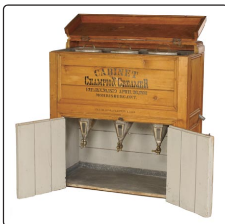
De l'eau froide était versée dans la partie supérieure de l'écumeuse Champion Cabinet Creamer pour accélérer la séparation du lait et de la crème. Le lait s'écoulait par les trois robinets situés au bas des contenants (730341).
