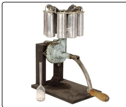
Cet appareil Babcock provient de la compagnie Ketchum Manufacturing d'Ottawa. Il a été utilisé dans le laboratoire de technologie laitière de la Ferme expérimentale centrale (790290).
