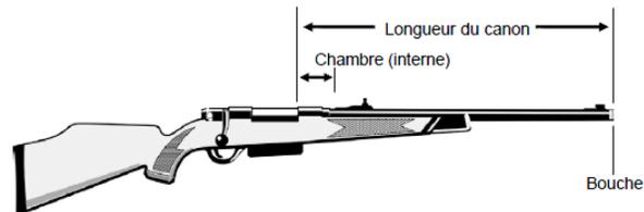
La longueur du canon d'un revolver ne comprend pas le barillet. Elle se mesure par la distance entre la bouche du canon et la tranche de la culasse juste devant le barillet. Mesurez de la bouche à la chambre inclusivement (par exemple, en insérant la baguette de nettoyage dans le canon lorsque le mécanisme est fermé). Inscrivez une coche dans la case correspondant à l'unité de mesure (millimètres ou pouces).
