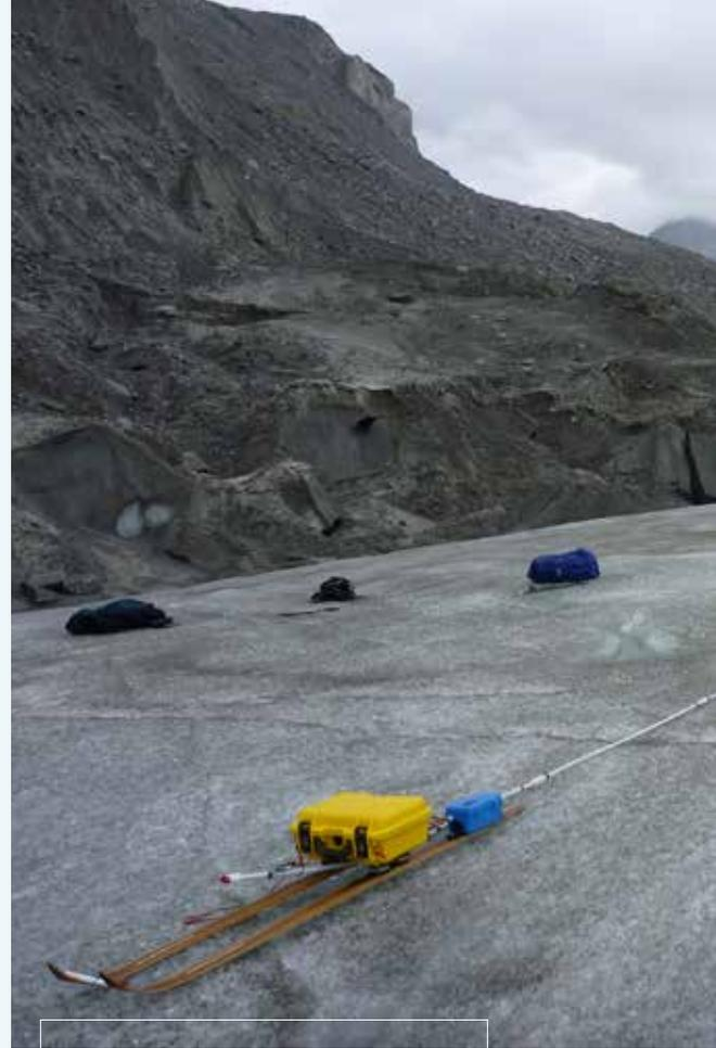
Au moyen d'un radar pénétrant à bifréquence, des chercheurs mesurent la masse volumique du glacier Fantail.
