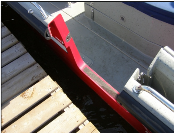
Photo 2. Side door opened inward
