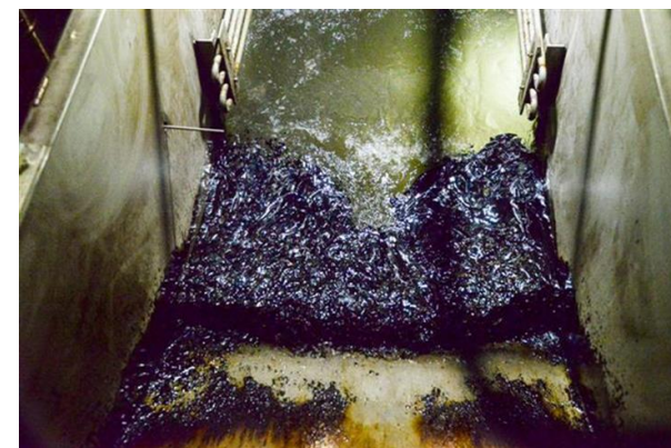
Bassin de simulation de vagues : bitume dilué déversé dans de l'eau provenant de la rivière Saskatchewan Nord et contenant 2000 ppm de sédiments
